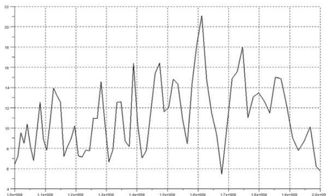
Рис.14. Результаты измерения напряженности поля внутри корпуса при воздействии внешнего поля напряженностью 30 В/м на переднюю (лицевую) сторону ИО в диапазоне частот 1 - 2 ГГц (левая кривая) и 2 - 2,5 ГГц (правая кривая) при вертикальной поляризации излучающей антенны: E_{M_{верт}}=21 В/м, f \approx 1,62 ГГц; E_{M_{верт}}=20,5 В/м, f \approx 2,12 ГГц
